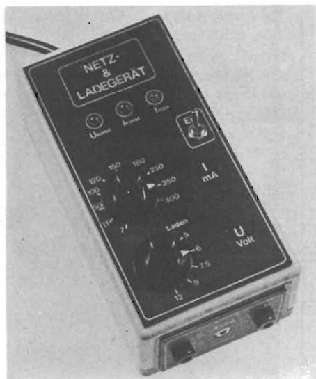
Fig. 1 - Alimentatore combinato con un caricabatterie. L'azionamento è molto semplice, grazie alle 5 tensioni fisse di uscita ed ai 10 valori di corrente, che possono essere predisposti mediante commutatori.
