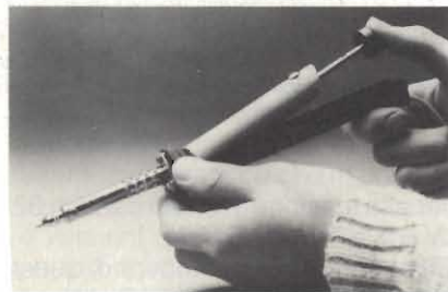
Saldatore/dissaldatore elettrico con punte facilmente intercambiabili.
