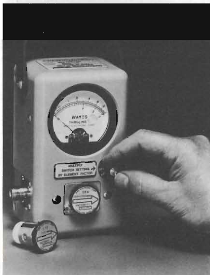
Misuratore di potenza RF munito di un amplificatore interno con 7 portate.
