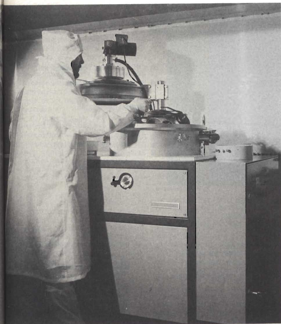
Sistema a radio frequenza per la vaporizzazione dell'alluminio e sua deposizione sul chip di silicio. L'alluminio serve a formare gli elettrodi.
